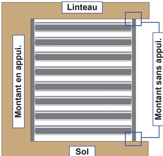
La pose en appuis un côté consiste à fixer le brise soleil CLAUSTRA en 3 points. Fixation du montant en appuis sur le mur et fixation des deux platines de fixation au sol et sous linteau.
