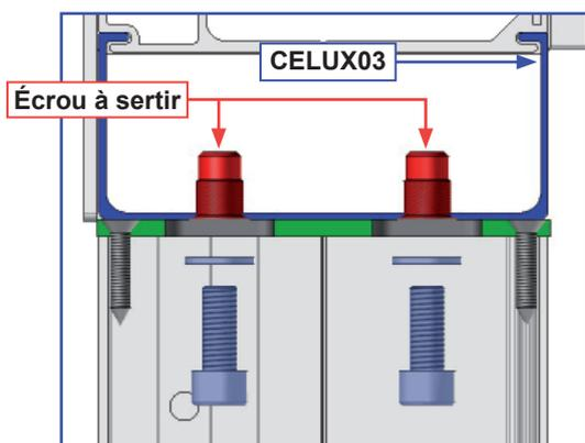
Répéter les opérations du paragraphe 2 page 3. Mais réaliser la fixation du montant sur le PBSO45 à l'aide d'un kit de vis Ø8mm non fourni.
